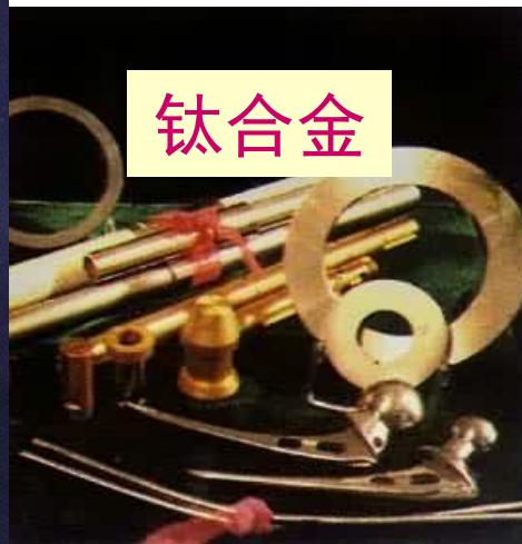
钛-铝-钒合金 (90%Ti,6%Al,4%V)用来制作骨 螺钉，人工关节
