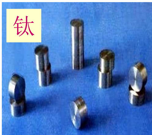
钛-铝-钒合金 (90%Ti,6%Al,4%V)用来制作骨 螺钉，人工关节
